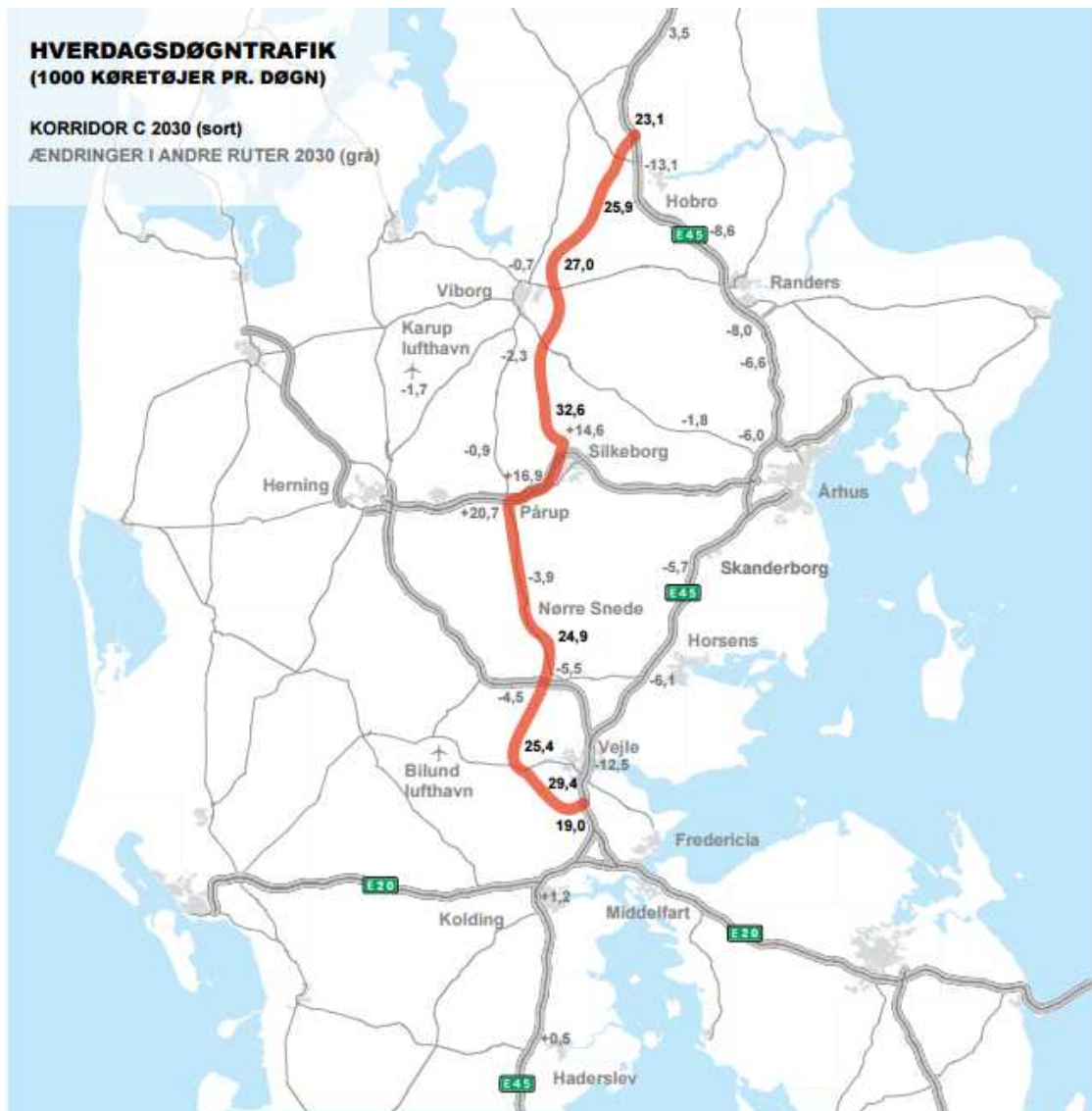
Kort 5.5: Hverdagsdøgntrafik på en midtjysk motorvej i korridor C, eller mertrafik på eksisterende strækninger, og ændringer i antal køretøjer på hovedvejene i Jylland i 2030.
