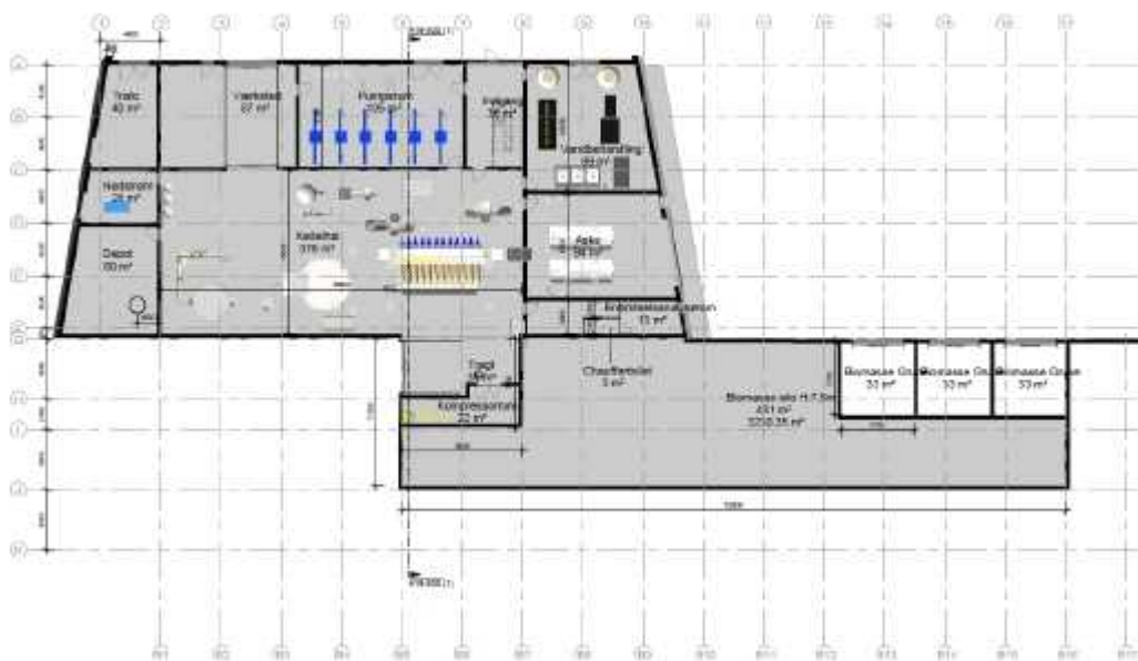
Fig. xx Oversigt over indretning af biomassevarmeværkets bygning
