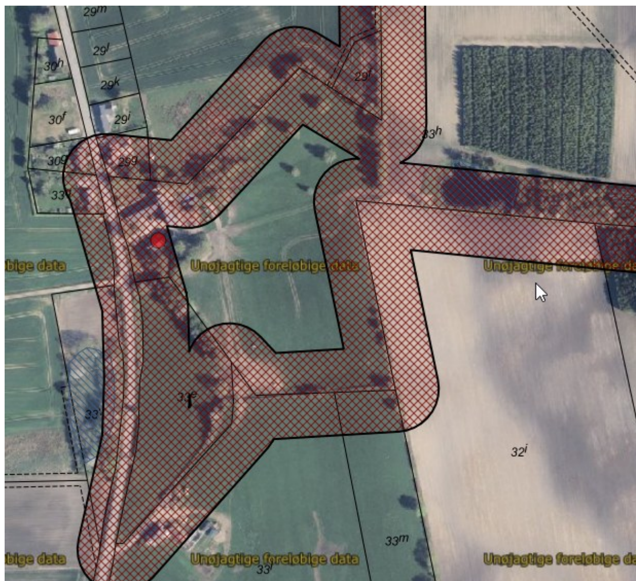
Figur 4: De skraverede områder angiver hvor der er mindre end 30 meter til naboskel.
