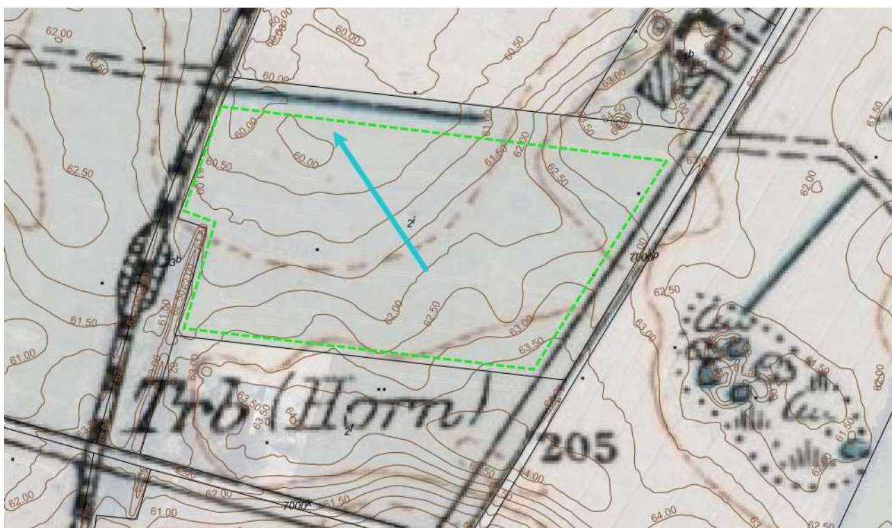
Figur 10. zoom ind af målebordskortet, på marken hvor der udsprinkles. På dette kort er der tilføjet højdekurver og den blå pil, viser at højdekurverne falder ned mod grøften.
