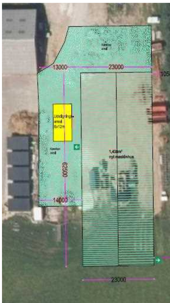
Figur 1. placering og dimensionering af det nye maskinhus.
