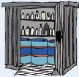
Figur 2: Udendørs opbevaring i container med dobbelt bund.
