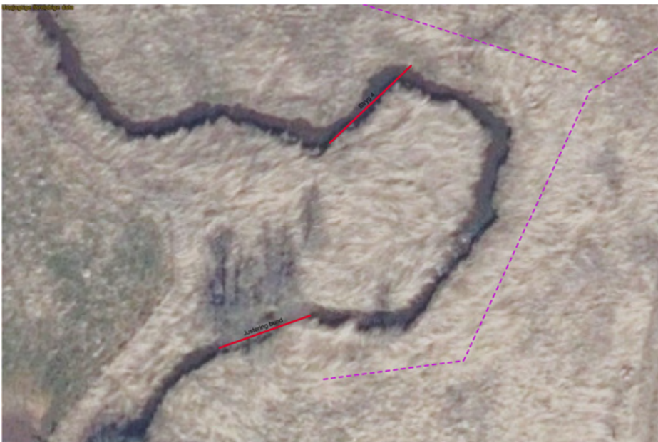
Fig 4-11. Stryg 4, som opbygges i sten, etableres nedenfor et eksisterende stenstryg/-styrt, som samtidig gøres mere passabelt ved at justere på de sten, der udgør styrtet.
