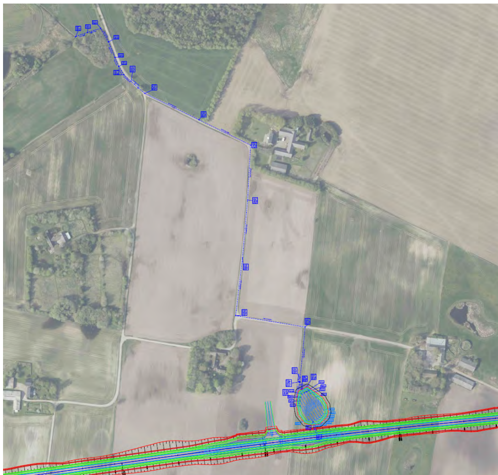
Figur 4-5 Forslag til placering af nyt regnvandsbassin langs med Høje Kejlstrupvejs forlængelse (st. 1500) samt placering af ledninger og grøft til recipient.
