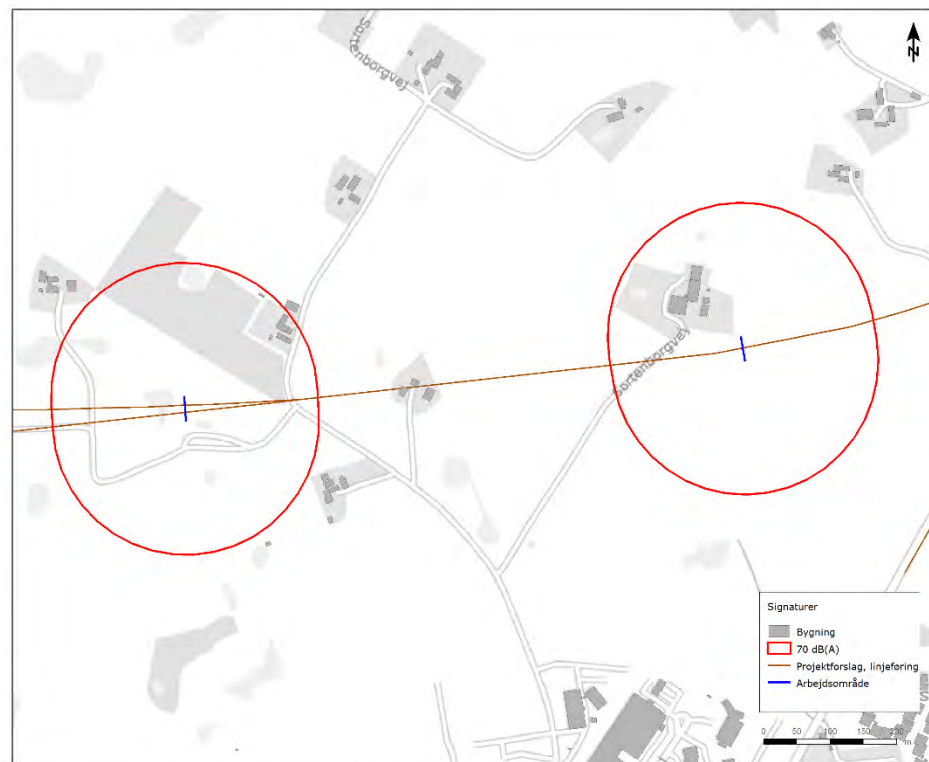
Figur 8-6 Støj fra etablering af faunapassage (hhv. underføring og paddepassage) ved Sortenborgvej. Rød linje omkranser de områder, der kan blive udsat for støj over 70 dB(A) fra anlægsarbejde, der udføres i anlægsområdet (blå linje).
