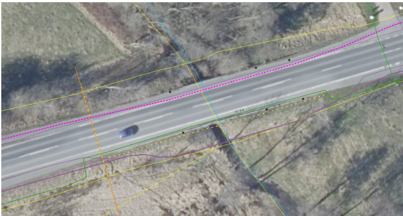
Figur 3. Krydsningen af Linå med fjernvarmeledning er vist med en lyserød, stiptet linje. Vandløbet er markeret med en blå linje.
