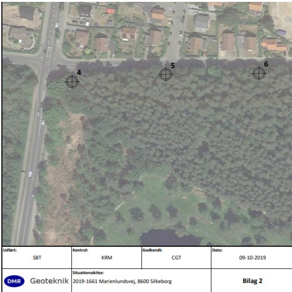
Figur 4: Boring nr. 6 fra 2019 er brugt til dimensionering af faskinen. Kortet viser boringens placering.
