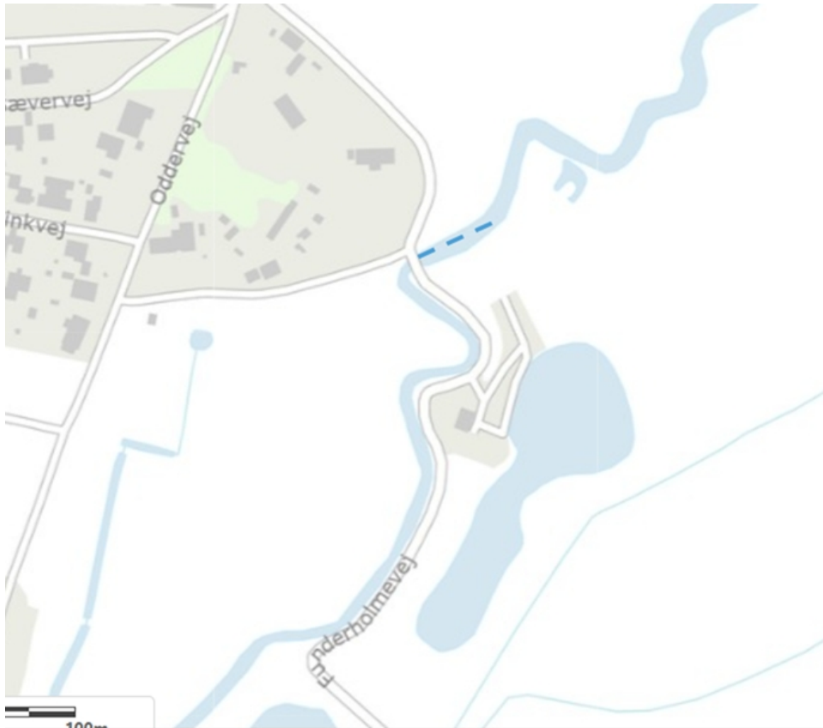
Figur 2. Delområde A - Funderholmevej. Her udlægges 10 m 3 grus og 3-4 m 3 sten i vandløbskant markeret med blå stiplede linje på nedenstående kortudsnit.
