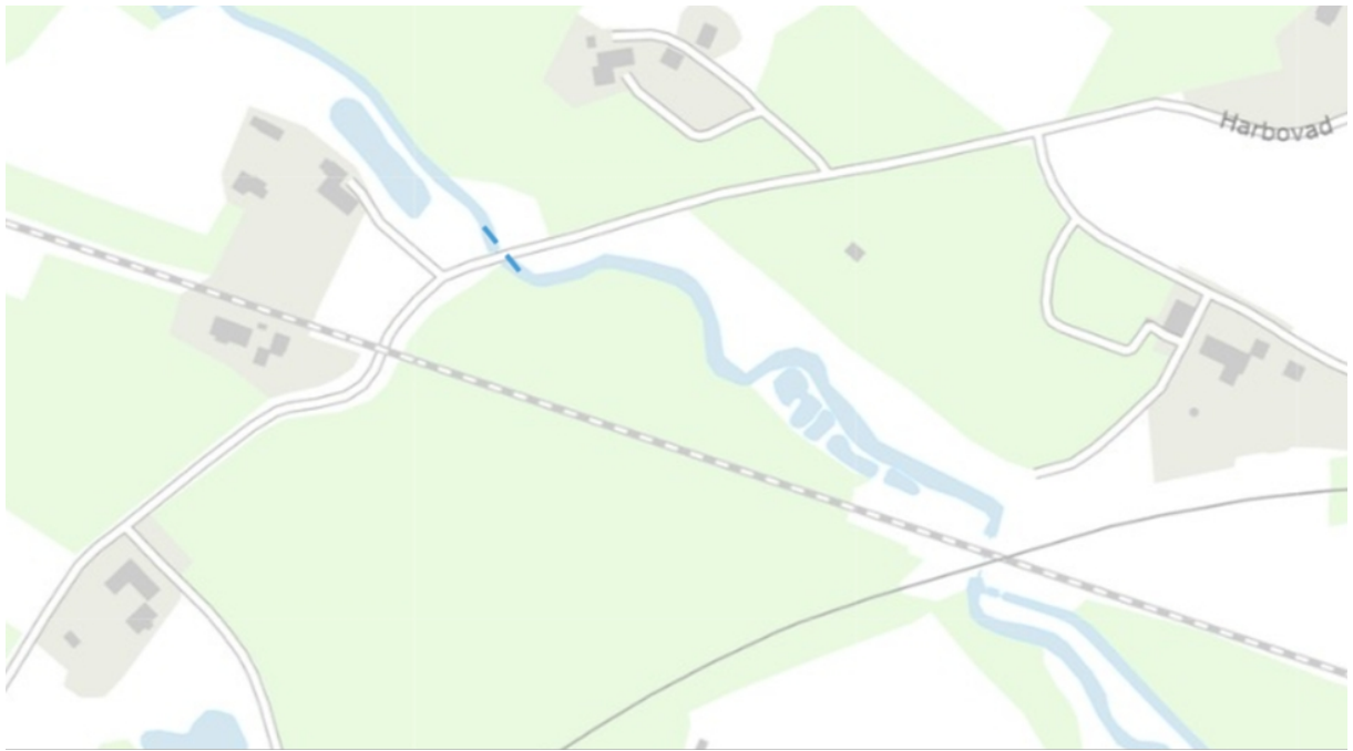
Figur 5. Delområde D - Harbovad. Her udlægges 10 m 3 grus og 1-2 m 3 sten langs vandløbskanten markeret med blå stiplede linje på kortudsnittet nedenfor.
