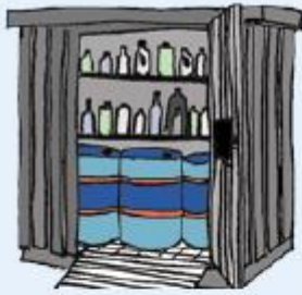
Figur 2: Udendørs opbevaring i container med dobbelt bund.
