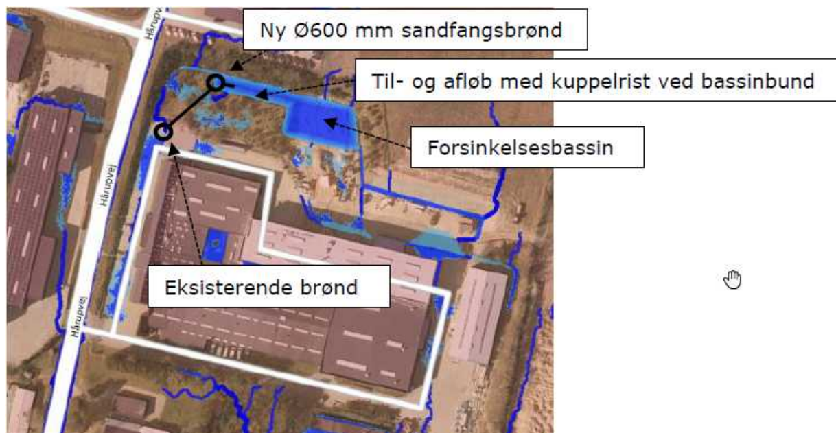
Figur 1. Placering af forsinkelsesbassin med afløb til off. kloak.
